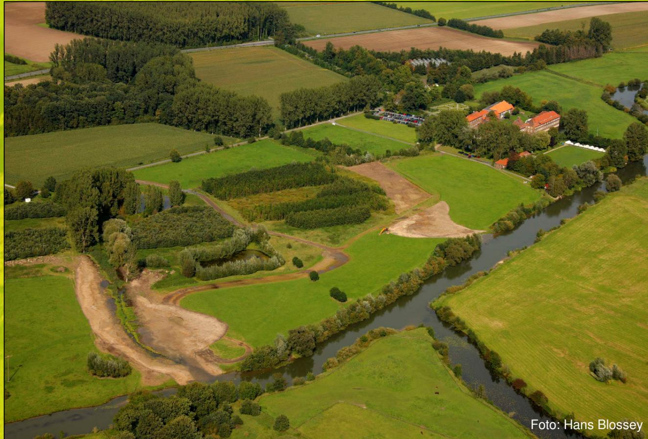
Der Maßnahmenblock Mühlenlaar nach Abschluss eines Großteils der Baumaßnahmen. Sehr gut zu erkennen ist die Aufweitung des Westhusener Baches (links im Bild) und die Anlage der neuen Flutmulde (mittig im Bild).
