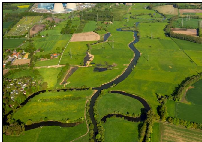
Luftbild von der Heidemühle während der Umsetzung der Baumaßnahmen. Gut erkennbar ist die bereits fertig gestellte Randsumpfung, die im Bild links parallel zur Lippe verläuft. Das große Stillgewässer rechtsseitig der Lippe ist zu diesem Zeitpunkt noch nicht angelegt worden (Foto: Hans Blosssey).
